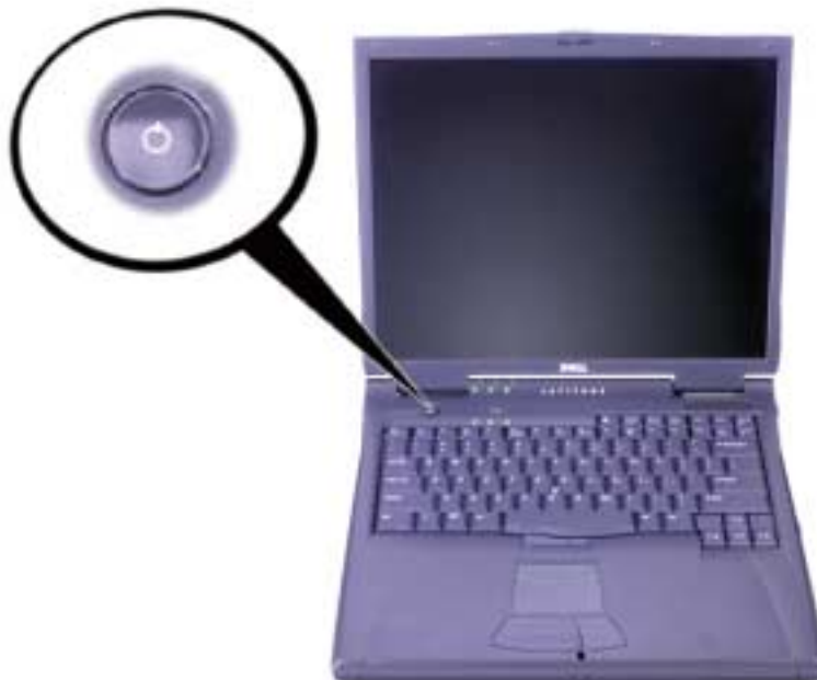
Figura 4-3. Encendido del ordenador
